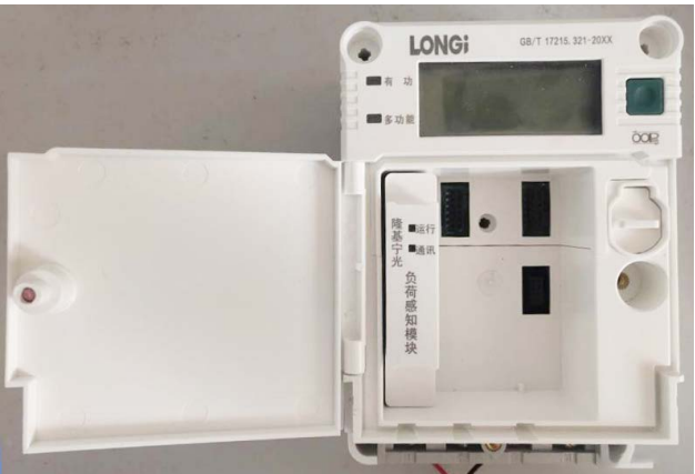
图3 将非侵入式负荷感知模块嵌入多芯模组化智能电能表
